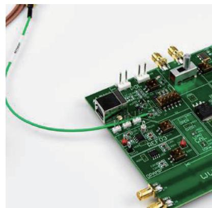
Keysight N7020A 电源探头及随附配件可与随附的同轴尾纤探头 (N7021A) 结合使用以探测目标。
