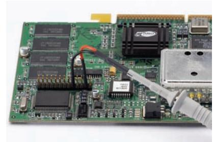
配有微型 SMD 线夹的双线适配器：微型 SMD 线夹旨在提供快速便捷的免手持式表面贴装型电容器探测，需要同双线适配器结合使用。
