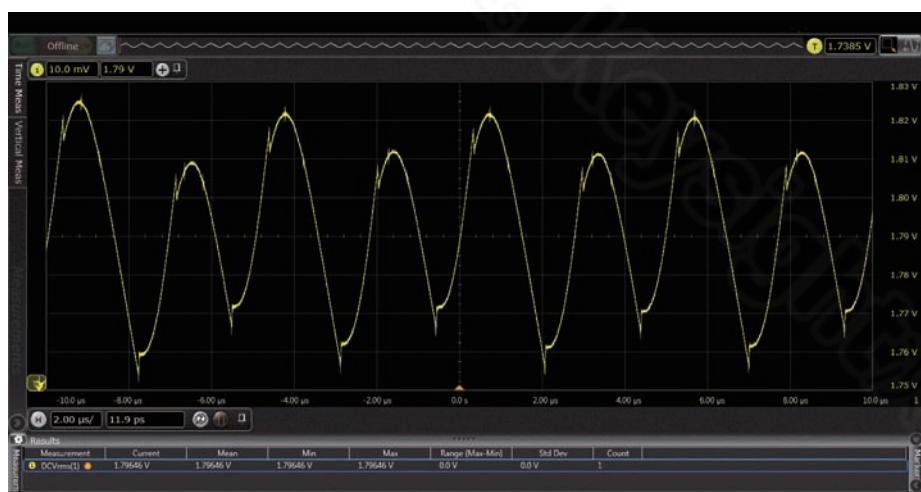
2 GHz 带宽和  $50 \text{ k}\Omega$  直流负载的 N7020A 电源完整性探头可以显示直流电源轨的交流和直流分量。
