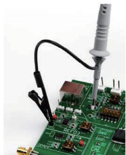
双线适配器：双线适配器可以帮助您轻松连接 N7023A 点测探头前端与采用 0.025 英寸方针的常用 0.1 英寸排针。该双线适配器所有外部金属表面完全绝缘，可以避免短路危险。
