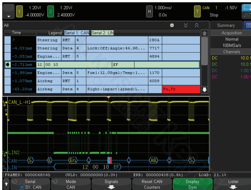
图 1(a). 使用 Keysight InfiniiVision X 系列示波器同时解码 LIN 总线和 CAN 总线。
